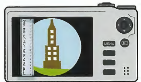
双眼鏡とデジカメの組み合わせにあわせて縮尺のものさしのコピーを貼りつけるのだ。
